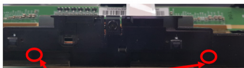
Points de verrouillage (sans vis)
