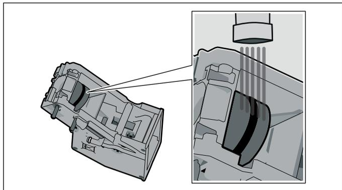
11. Nettoyer soigneusement les bouchons de raccordement de l'unité de percolation.
