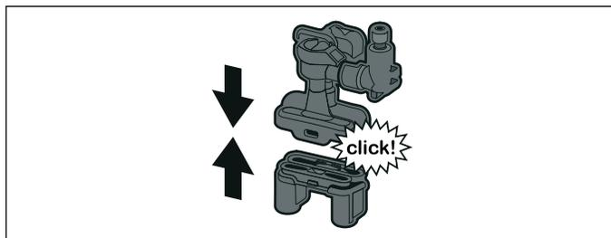
8. Remettre la buse d'écoulement en place sur les trois raccordements.
