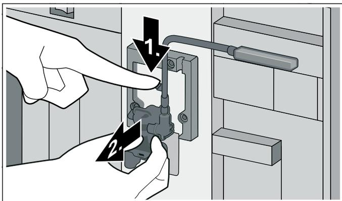
3. Retirer le tuyau à lait. Démontez la partie supérieure et la partie inférieure de la buse d'écoulement.
