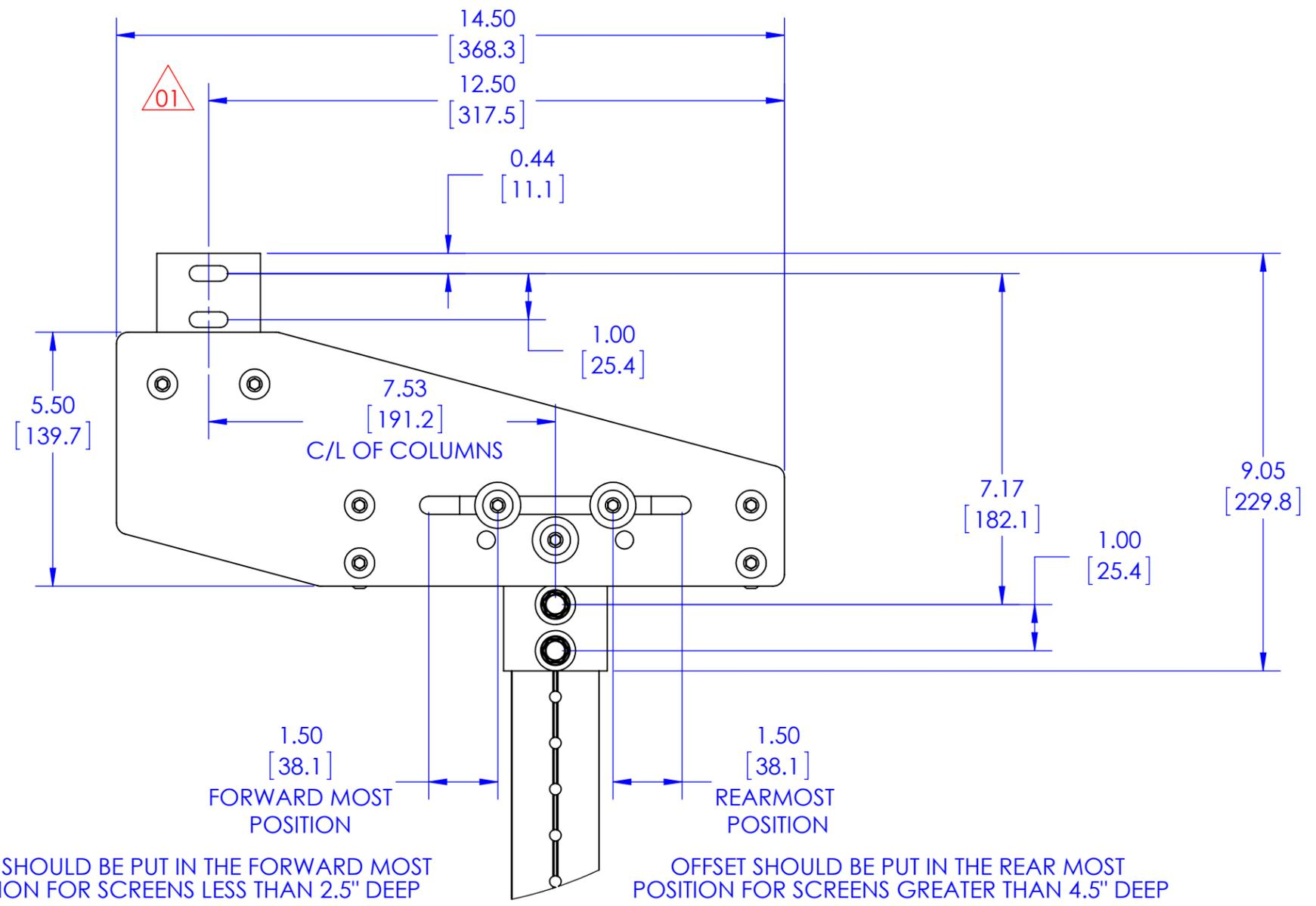
OFFSET SHOULD BE PUT IN THE FORWARD MOST POSITION FOR SCREENS LESS THAN 2.5" DEEP
