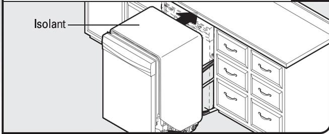
**IMPORTANT :** Si l'on enlève les roulettes, recouvrir le plancher afin d'éviter de l'endommager lors des déplacements du lave-vaisselle. Insérer lentement et complètement le lave-vaisselle dans l'ouverture d'encastrement du placard. Veiller à ne pas coincer ou déformer la canalisation de cuivre, le tuyau d'évacuation, le cordon d'alimentation ou le câble de raccordement direct entre le lave-vaisselle et le placard. Enlever le carton placé sous le lave-vaisselle.
