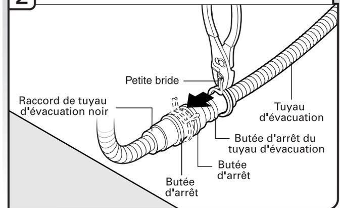
À l'aide d'une pince, ouvrir la petite bride de tuyau d'évacuation en la serrant et la faire glisser sur le connecteur, entre les butées.
