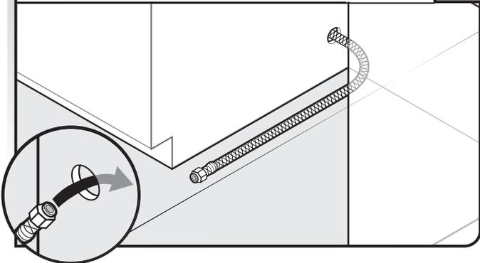
Faire passer prudemment la canalisation d'alimentation en eau à travers le trou percé dans le placard. (Un tube en cuivre s'écrase/se déforme facilement - procéder prudemment si l'on en utilise un). Il faut que la longueur de la section qui dépasse dans l'espace d'encastrement soit suffisante pour le raccordement à l'entrée du lave-vaisselle sur le côté gauche/à l'avant du lave-vaisselle.
