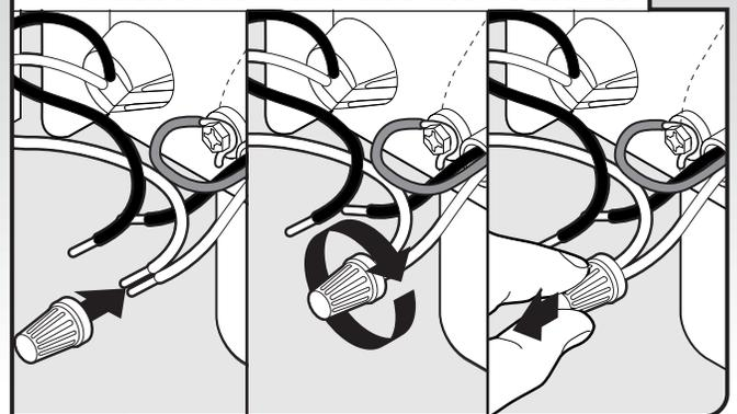
**REMARQUE :** Ne pas pré-torsader les brins des conducteurs. Installer un connecteur de fils (homologation UL ou CSA). Tirer doucement sur les conducteurs pour vérifier qu'ils sont bien fixés.
