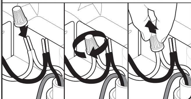
**REMARQUE :** Ne pas pré-torsader les brins des conducteurs. Installer le connecteur de fils en le faisant pivoter. Tirer doucement sur les conducteurs pour vérifier qu'ils sont bien fixés.
