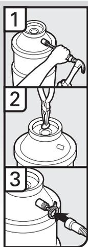
1. À l'aide d'un marteau et d'un tournevis, enfoncer le bouchon d'obturation dans le broyeur à déchets.
