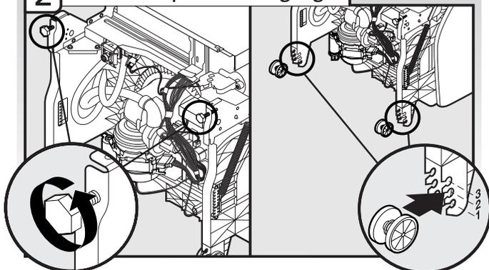
Ajuster (vissage) les deux pieds de réglage de l'aplomb à la même hauteur. Placer les roues à la position nécessaire selon les indications du "Tableau de réglage - Hauteur du lave-vaisselle".
