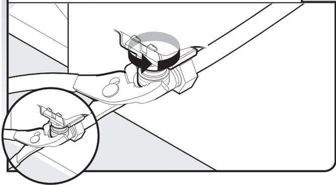
S'assurer que la rondelle de caoutchouc est correctement installée dans le raccord. Enfiler le raccord de  $\frac{3}{4}$ " vers le haut jusqu'à la valve et serrer à la main afin d'éviter de fausser le filetage. Serrer à la main jusqu'à ce que le raccord soit serré.
