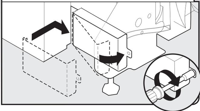
Placer les conducteurs à l'intérieur du boîtier de connexion. Insérer les languettes du côté gauche du couvercle. S'assurer que les fils sont bien logés à l'intérieur du boîtier. Fermer le couvercle tout en veillant à ne pas coincer de fils. Fixer le couvercle à l'aide d'un tourne-écrou de 1/4" ou d'un tournevis Torx® T20® et de la vis précédemment retirée.
