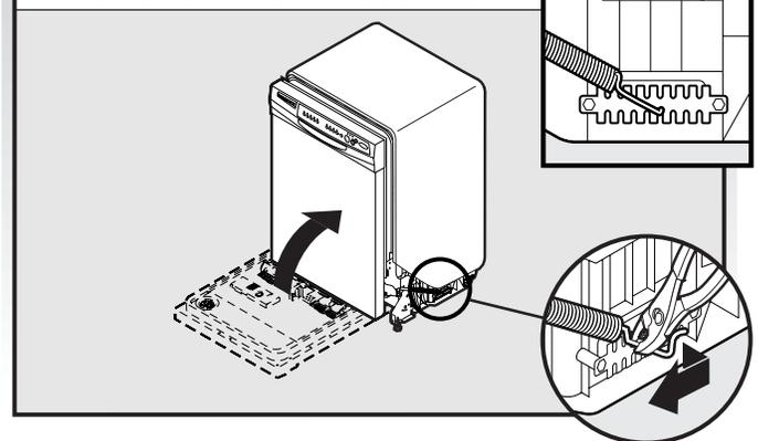
Si la porte se ferme trop rapidement, réduire la tension des ressorts : déplacer le point d'ancrage de l'extrémité du ressort vers l'avant du lave-vaisselle.
