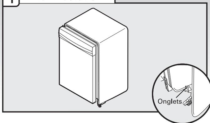
En utilisant les fentes précoupées dans l'isolation, fixer l'excédent d'isolation sur les crochets moulés sur la cuve. Veiller à fixer l'isolation sur les deux côtés de la cuve.
