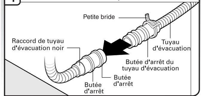
Placer une serviette sous le tuyau d'évacuation pour récupérer l'eau restée dans le tuyau d'évacuation. Placer la petite bride pour tuyau d'évacuation sur la petite extrémité du tuyau d'évacuation. Enfoncer le tuyau d'évacuation neuf dans le connecteur noir de tuyau d'évacuation jusqu'à la butée d'arrêt du tuyau d'évacuation.
