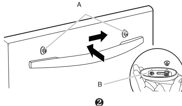
A. Anchors / Anclajes / Ancrages
