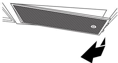
2. Réinstaller le filtre à graisse en insérant une extrémité du filtre dans le rebord gauche du cadre. Orienter la partie droite du filtre vers le haut et l'insérer pour l'emboîter.
