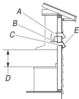
A. Conduit rond de diamètre 6" (15,2 cm) ou plus ou conduit rectangulaire de 3/4" x 10" (8,3 x 25,4 cm) à travers le toit
