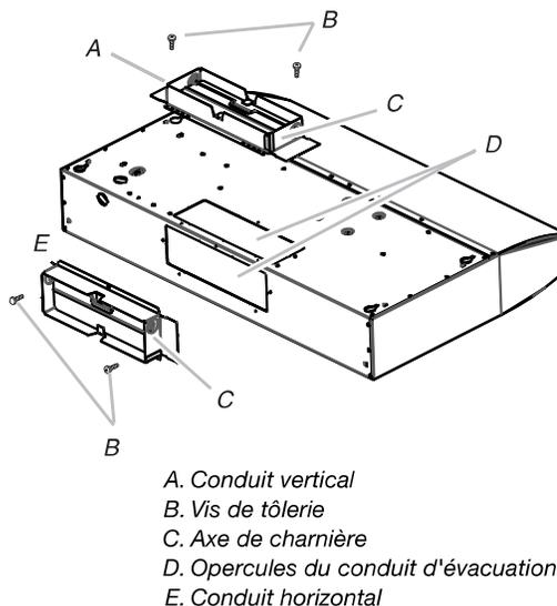
**REMARQUE :** Si la bouche de décharge murale est située directement derrière le connecteur de conduit, on doit veiller à empêcher toute interférence entre les clapets du connecteur et de la bouche de décharge murale. En cas d'interférence, supprimer le clapet du connecteur de conduit.
