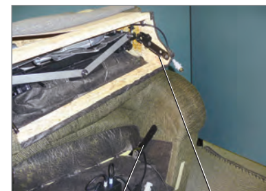
Soporte de la estructura Soporte del respaldo
