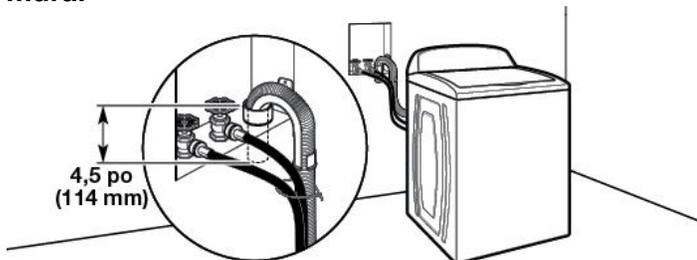
Voir les exigences dans la section « système de vidange avec tuyau de rejet à l'égout au plancher ».
