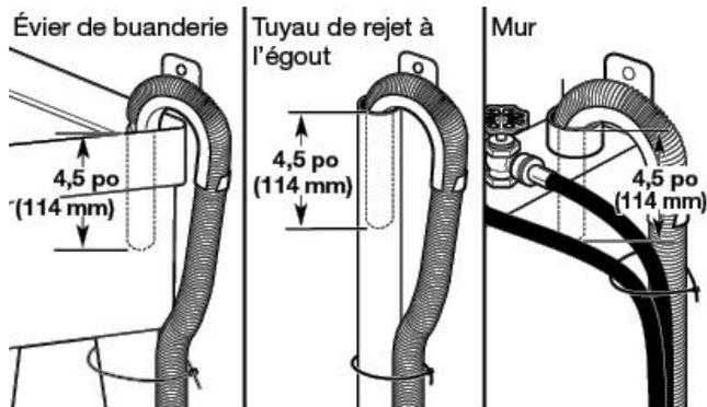
Fixer le tuyau de vidange au pied de l'évier de buanderie, au tuyau de rejet à l'égout ou aux tuyaux d'arrivée d'eau pour le tuyau de rejet à l'égout mural avec l'attache-câble.
