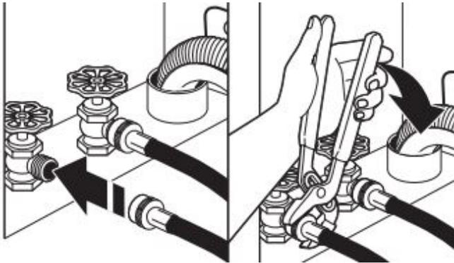
**IMPORTANT:** Ne pas trop serrer le tuyau, utiliser du ruban ou appliquer du calfeutrant sur le robinet. Cela pourrait endommager le robinet.
