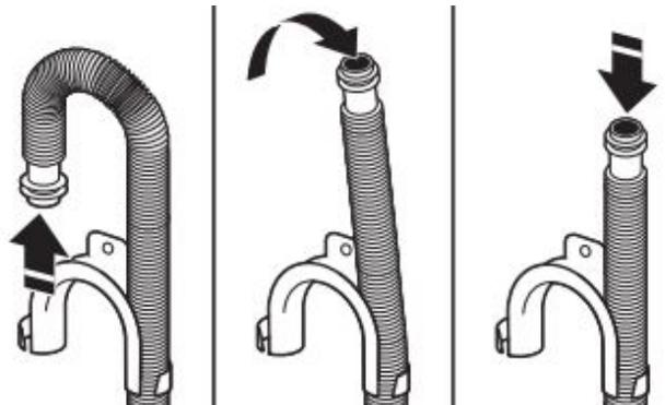
Pour les installations avec vidange au plancher, il faut retirer la bride de retenue pour tuyau de vidange de l'extrémité du tuyau de vidange. Des pièces supplémentaires avec des directives distinctes seront peut-être nécessaires. Voir la section « Outils et pièces ».
