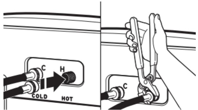
**IMPORTANT:** Pour réduire les risques de défaillance d'un tuyau, remplacer les tuyaux tous les 5 ans. Prendre en note les dates d'installation ou de remplacement des tuyaux pour référence future.
