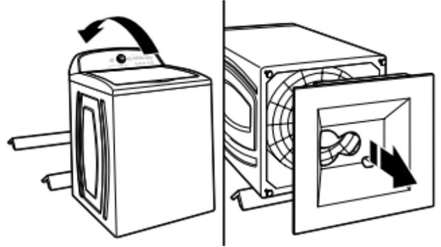
Afin d'éviter d'endommager le plancher, placer les supports en carton du carton d'expédition sur le plancher, derrière la laveuse. Incliner la laveuse vers l'arrière et la placer sur les supports en carton. Retirer la base d'expédition (certains modèles demandent que la base d'expédition soit tournée de 90° vers la droite avant d'être enlevée). Redresser la laveuse en position verticale.
