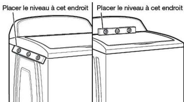
Mettre la laveuse est à son emplacement final. Placer un niveau sur les bords supérieurs de la laveuse. Utiliser une rive latérale comme guide pour déterminer l'aplomb des côtés. Vérifier l'aplomb de l'avant à l'aide du couvercle, tel qu'indiqué. Faire bouger la laveuse d'avant en arrière pour s'assurer que les quatre pieds sont bien en contact avec le plancher. Si la laveuse est d'aplomb, passer à l'étape 15.
