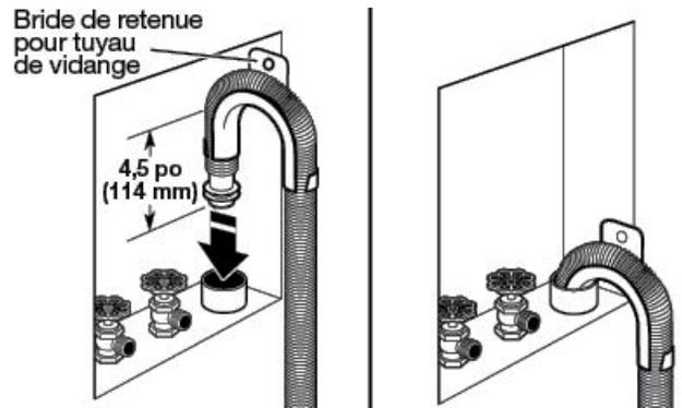
**IMPORTANT :** 4,5 po (114 mm) du tuyau de vidange doit être à l'intérieur du tuyau de rejet à l'égout; ne pas forcer l'excédent de tuyau dans le tuyau de rejet à l'égout ni le placer dans l'évier de buanderie. On doit utiliser la bride de retenue pour tuyau de vidange.
