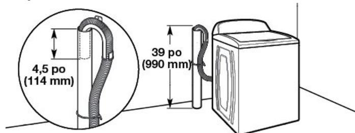
Diamètre minimal pour un tuyau de rejet à l'égout : 2 po (51 mm).
