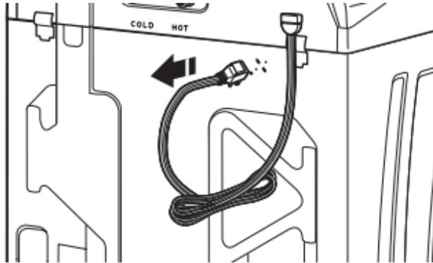
Saisir fermement le cordon d'alimentation et le tirer pour le libérer du panneau arrière. Placer délicatement le cordon d'alimentation par dessus la console pour permettre le libre accès à l'arrière de la laveuse.
