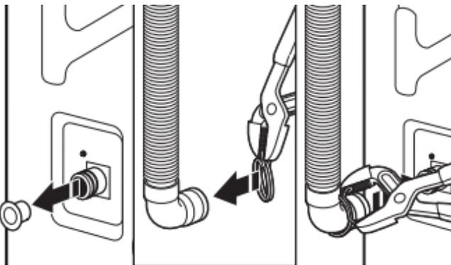
Le cas échéant, retirer le bouchon en plastique rouge de l'orifice de vidange noir situé à l'arrière de la laveuse.
