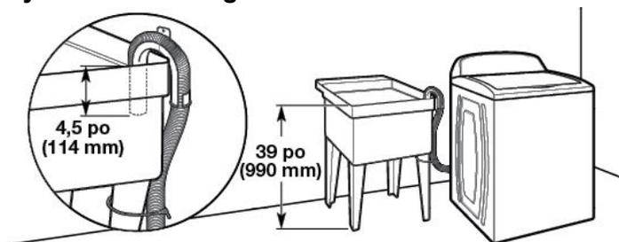
Capacité minimale : 20 gallon (76 L). Le sommet de l'évier de buanderie doit se trouver à au moins 39 po (990 mm) du plancher; ne pas l'installer à plus de 96 po (2,44 m) du fond de la laveuse.
