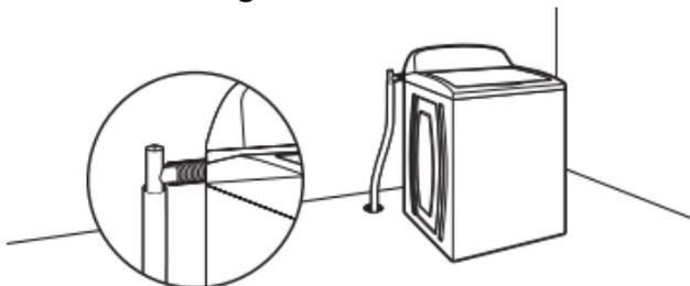
Le système de vidange au sol requiert un ensemble de brise-siphon, deux ensembles de raccordement et une rallonge de tuyau de vidange qui peuvent être achetés séparément; consulter le guide de démarrage rapide pour les renseignements de commande en ligne. Hauteur minimale du brise-siphon : 28 po (710 mm) du bas de la laveuse (des tuyaux supplémentaires peuvent être requis).
