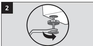
Level the pedestal with a wrench, adjusting all four legs as necessary. Make sure that the pedestal is level side to side and back to front. Do not tighten the locknuts above the feet at this time. Nivele el pedestal con una llave inglesa ajustando las cuatro patas según sea necesario. Asegúrese de que el pedestal esté nivelado de lado a lado y de adelante hacia atrás. No apriete aún la contratuerca que está encima de las patas.
