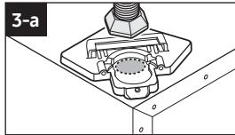
Place the feet of the dryer in the inner circle of the safe landing grooves on the pedestal. The location of the safe landing groove for the dryer is highlighted above. Coloque las patas de la secadora en el círculo interior de las ranuras de posición segura del pedestal. La ubicación de las ranuras de posición segura de la secadora se destaca en la ilustración superior.
