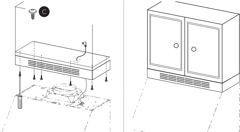
**5** Installez la hotte de la cuisinière au bas du kit sans conduit. Installez la hotte dans le mur comme indiqué dans les instructions d'installation de la hotte, et ajustez la hotte pour qu'elle soit au même niveau que le kit sans conduit. Fixez la hotte au kit sans conduit à l'aide de 4 vis (**D**).
