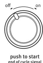
Tourner le bouton END OF CYCLE SIGNAL (signal de fin de programme) pour activer ou désactiver (On ou Off) le signal. Le signal de fin de programme est un signal sonore qui retentit lorsque le programme de séchage est terminé. Sortir rapidement les vêtements à la fin du programme réduit le froissement.
