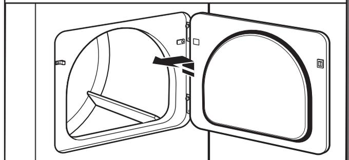
Soulever la porte jusqu'à ce que les vis supérieures situées dans la caisse de la sècheuse se trouvent dans la partie évasée de l'encoche de charnière. Tirer la porte vers l'avant pour la dégager des vis. Placer la porte (côté poignée vers le haut) sur la sècheuse. Retirer les vis supérieures de la caisse de la sècheuse.
