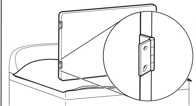
Réinstaller les charnières de porte sur la porte de la sécheuse de façon à ce que le trou le plus gros se trouve dans la partie inférieure de la charnière.
