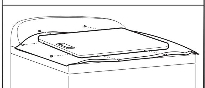
Retirer les vis du sommet, du bas et du côté de la porte (6 vis). Conserver séparément les vis de porte et les vis de charnière, car elles sont de tailles différentes. Tout en maintenant la porte sur la serviette et sur la sècheuse, saisir les côtés de la porte externe et la soulever pour la séparer de la porte interne.
