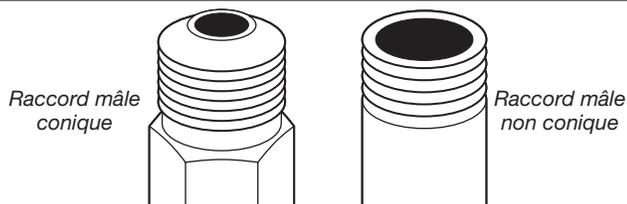
Retirer le capuchon rouge de la canalisation de gaz. À l'aide d'une clé pour serrer, raccorder l'alimentation en gaz à la sècheuse. Utiliser un composé d'étanchéité des tuyauteries sur tous les filetages des raccords mâles non coniques. Si on utilise un conduit métallique souple, veiller à ce qu'il ne soit pas pincé.
