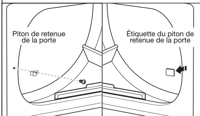
Retirer le pignon de retenue de la porte et son étiquette de la caisse de la sécheuse. Insérer le pignon de retenue de la porte dans le trou duquel l'étiquette a été retirée et fixer avec une vis. Obtenir le trou d'origine du pignon de retenue de la porte avec l'étiquette et appuyer fermement pour la maintenir en place.
