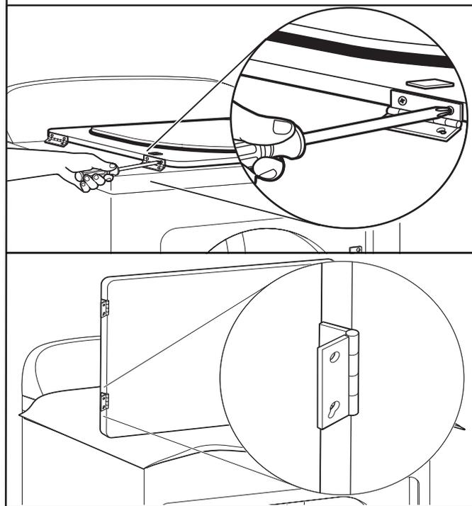
Réinstaller les charnières de porte sur la porte de la sècheuse de façon à ce que le trou le plus gros se trouve dans la partie inférieure de la charnière.
