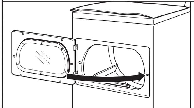
Fermer la porte et vérifier que le pignon de la porte est aligné avec la gâche de la porte. Au besoin, faire glisser la gâche de la porte vers la gauche ou vers la droite à l'intérieur de l'encoche pour régler l'alignement.
