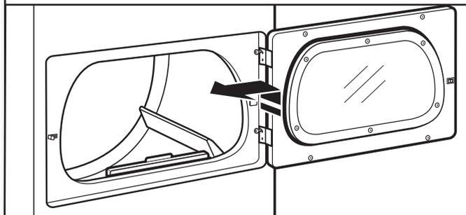
Soulever la porte jusqu'à ce que les vis supérieures situées dans la caisse de la sècheuse se trouvent dans la partie évasée de l'encoche de charnière. Tirer la porte vers l'avant pour la dégager des vis. Placer la porte (côté poignée vers le haut) sur la sècheuse. Retirer les vis supérieures de la caisse de la sècheuse.
