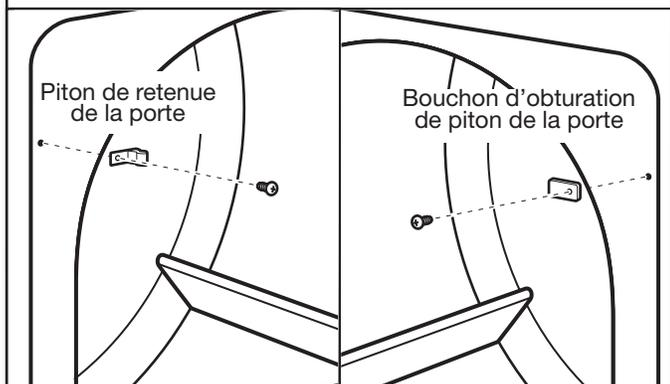
Retirer le piton de retenue de la porte et le bouchon d'obturation de piton de la porte de la caisse de la sécheuse. Insérer le piton de retenue de la porte dans le trou du bouchon d'obturation de piton de la porte et fixer avec une vis. Insérer le bouchon d'obturation de piton de la porte dans le trou d'origine de piton de la porte et fixer avec une vis.
