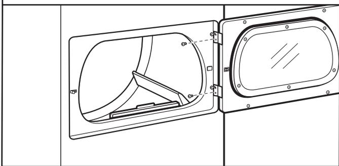
Ouvrir la porte de la sècheuse. Ôter les vis inférieures de la portion des charnières attachée à la caisse de la sècheuse. Desserrer (ne pas retirer) les vis supérieures de la portion des charnières attachée à la caisse de la sècheuse.
