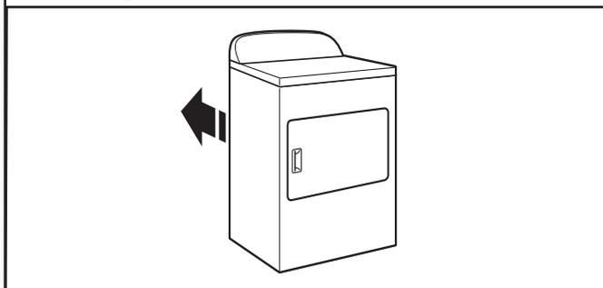
Placer la sécheuse à son emplacement final. Éviter d'écraser ou de déformer le conduit d'évacuation.
