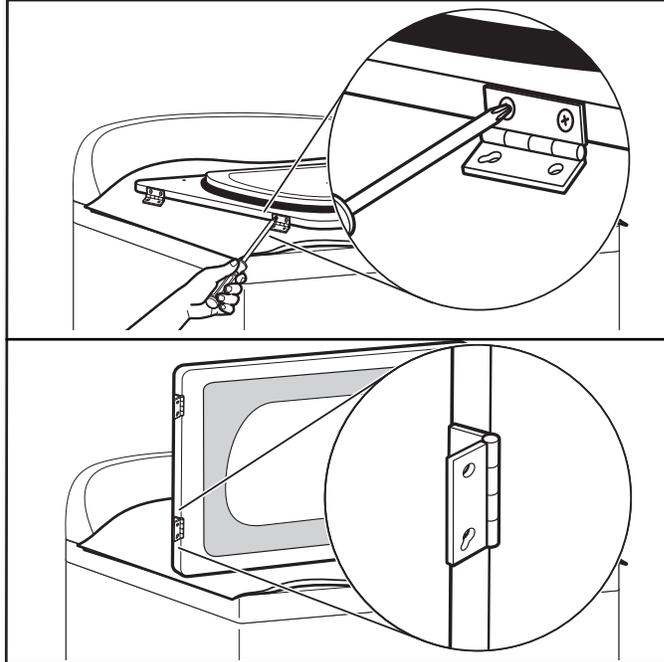
Réinstaller les charnières de porte sur la porte de la sécheuse de façon à ce que le trou le plus gros se trouve dans la partie inférieure de la charnière.
