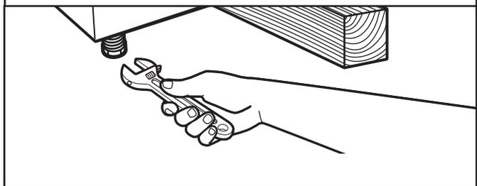
Si la sécheuse n'est pas d'aplomb ou à la même hauteur que la laveuse, la soulever à l'aide d'une cale en bois. Utiliser une clé pour ajuster les pieds vers le haut ou vers le bas, et vérifier à nouveau si elle est d'aplomb. Une fois que les pieds sont d'aplomb, s'assurer que les quatre pieds sont solidement appuyés contre le plancher avant de les serrer.
