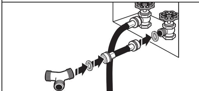
Fixer le tuyau d'alimentation de 2 pi (0,6 m) au robinet d'eau froide. Visser le raccord à la main pour qu'il repose sur le robinet. Fixer le raccord en "Y" à l'extrémité du tuyau d'alimentation de 2 pi (0,6 m). Visser le raccord à la main jusqu'à ce qu'il repose sur le raccord en "Y".
