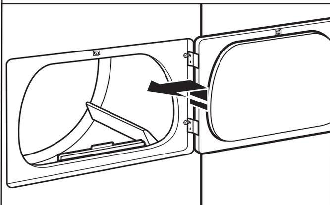
Soulever la porte jusqu'à ce que les vis supérieures situées dans la caisse de la sècheuse se trouvent dans la partie évasée de l'encoche de charnière. Tirer la porte vers l'avant pour la dégager des vis. Placer la porte (côté poignée vers le haut) sur la sècheuse. Retirer les vis supérieures de la caisse de la sècheuse.
