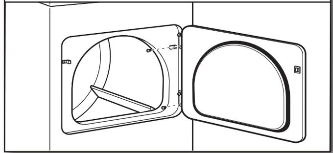
Ouvrir la porte de la sècheuse. Ôter les vis inférieures de la portion des charnières attachée à la caisse de la sècheuse. Desserrer (ne pas retirer) les vis supérieures de la portion des charnières attachée à la caisse de la sècheuse.
