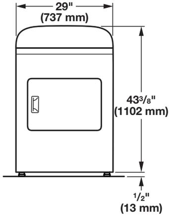
**REMARQUE :** Les pieds de nivellement doivent être de 1/2" (13 mm) (pour correspondre à la hauteur de la laveuse de 3,6 pi cu de capacité) ou 1 1/2" (38 mm) (pour correspondre à la hauteur de de la laveuse de 3,8 pi cu de capacité).
