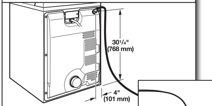
Fixer l'autre extrémité du long tuyau à l'électrovanne située au sommet du panneau arrière de la sécheuse. Visser le raccord à la main jusqu'à ce qu'il repose sur le connecteur de l'électrovanne. Terminer le serrage des raccords de deux tiers de tour supplémentaire avec une pince.
