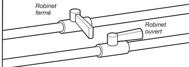
Ouvrir le robinet d'arrêt de la canalisation d'alimentation; le robinet est ouvert lorsque la manette est parallèle à la canalisation de gaz. Vérifier ensuite tous les raccords en les badigeonnant d'une solution de détection de fuites non corrosive approuvée. L'apparition de bulles indique la présence d'une fuite. Réparer toute fuite éventuelle.
