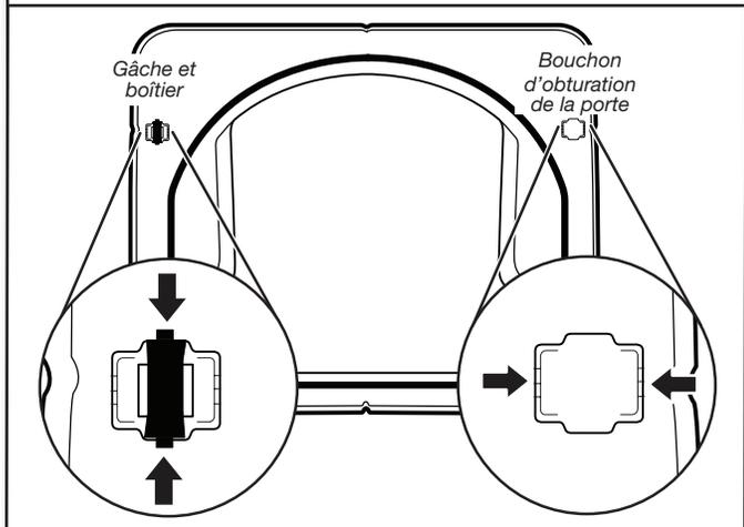
Retirer la gâche de porte, le boîtier et le bouchon d'obturation du côté intérieur de la porte interne en serrant les côtés puis en tirant/repoussant ces éléments. Placer la gâche de porte, le boîtier et le bouchon d'obturation de la porte sur le côté opposé à leur position précédente.
