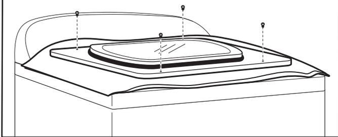
Retirer les vis du sommet, du bas et du côté de la porte (4 vis). Conserver séparément les vis de porte et les vis de charnière, car elles sont de tailles différentes.
