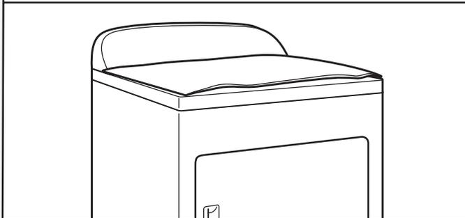
Placer une serviette sur le dessus de la sècheuse pour éviter d'endommager la surface.
