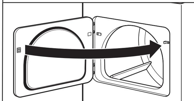
Fermer la porte et vérifier que le piton de la porte est aligné avec le piton de retenue de la porte. Au besoin, faire glisser la gâche de la porte vers la gauche ou vers la droite à l'intérieur de l'encoche pour régler l'alignement.
