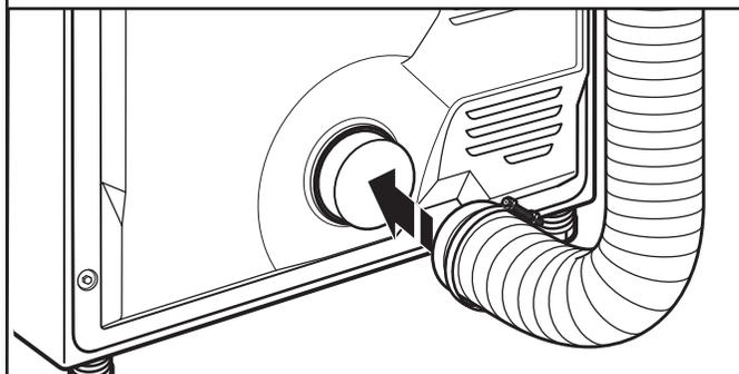
À l'aide d'une bride de serrage de 4" (102 mm), relier le conduit d'évacuation à la bouche d'évacuation de la sécheuse. Si on utilise le conduit d'évacuation existant, s'assurer qu'il est propre. Le conduit d'évacuation de la sécheuse doit être fixé par-dessus la bouche d'évacuation de la sécheuse, et à l'intérieur du clapet d'évacuation. Vérifier que le conduit d'évacuation est fixé au clapet d'évacuation à l'aide d'une bride de serrage de 4" (102 mm).
