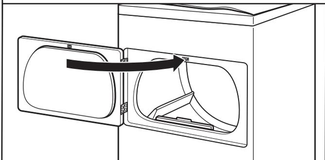
Fermer la porte et vérifier que le pignon de la porte est aligné avec la gâche de la porte. Au besoin, faire glisser la gâche de la porte vers la gauche ou vers la droite à l'intérieur de l'encoche pour régler l'alignement.
