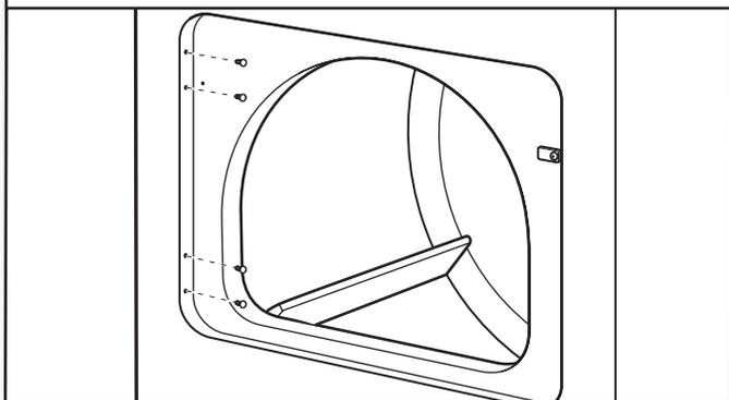
Utiliser un petit tournevis à lame plate pour retirer avec précaution les 4 bouchons d'obturation du côté gauche de la caisse de la sécheuse. Transférer les bouchons d'obturation dans les trous de charnière du côté opposé de la caisse de la sécheuse.
