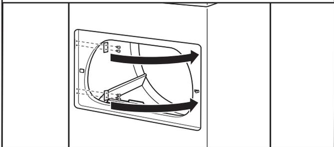
Ôter les 4 vis fixant les 2 bouchons d'obturation du côté gauche. Transférer les bouchons d'obturation au côté opposé à l'aide des mêmes 4 vis.
