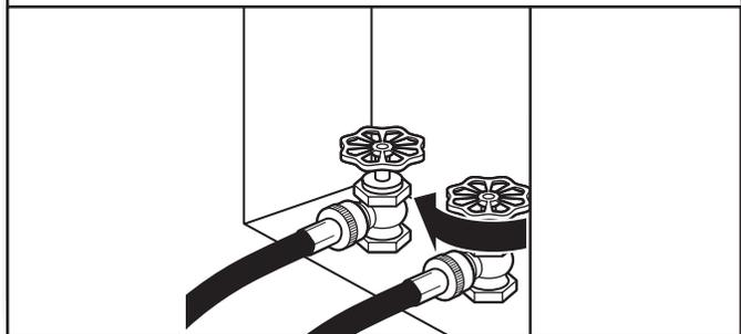
Fermer le robinet d'eau froide et ôter le tuyau d'alimentation de la laveuse.
