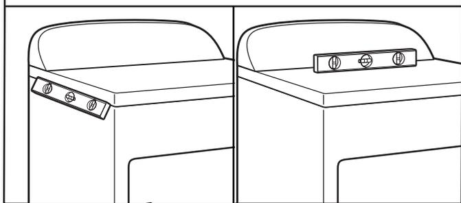
Vérifier l'aplomb de la sécheuse d'un côté à l'autre. Répéter l'opération de l'avant vers l'arrière.
