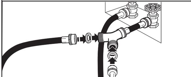
Fixer l'une des extrémités du tuyau d'alimentation de 5 pi (1,5 m) au connecteur en "Y". Fixer le tuyau d'alimentation en eau froide de la laveuse à l'autre extrémité du raccord en "Y". Visser le raccord à la main pour qu'il repose sur le raccord. Terminer le serrage des raccords de deux tiers de tour supplémentaire avec une pince.
