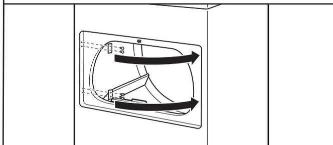
Ôter les 4 vis fixant les 2 bouchons d'obturation du côté gauche. Transférer les bouchons d'obturation au côté opposé à l'aide des mêmes 4 vis.
