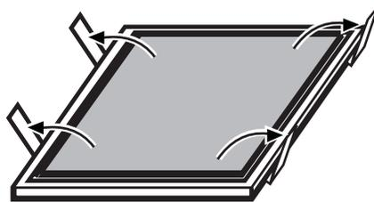
3. Placer le filtre à charbon dans la partie supérieure du filtre métallique.
