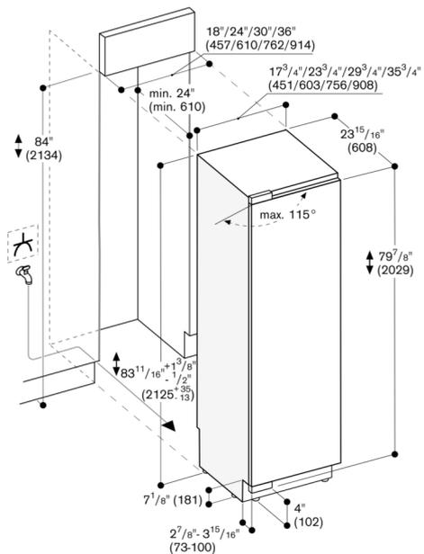
Les dimensions maximales de l'avant de la porte sont basées sur un écart de  $\pm 0,5$ mm.
