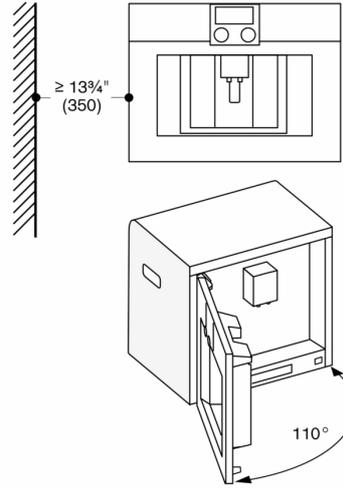
En cas d'utilisation d'un limiteur 92° pour charnière de porte (pièce de rechange n° 00636455), la distance minimale du mur n'est que d'environ 10 cm (100).
