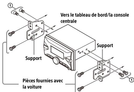
Si vous installez cet appareil sur les supports préinstallés de votre véhicule, faites passer les vis de montage ① par les trous de vis appropriés, en fonction de votre véhicule :
