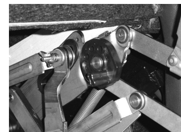
Tension moyenne du repose-jambes
