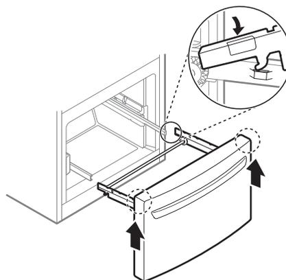
3 Abaissez la porte dans sa position finale et insérez les vis dans le rail situé des deux côtés.
