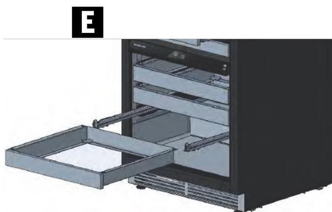
5. Une fois que l'étagère est hors des rails, placez-la à côté dans un emplacement sécuritaire avant d'adapter les deux rails de l'étagère. Pour ce faire, déverrouiller le mécanisme du rail de la tablette en appuyant sur la languette en acier au bas du rail vers l'arrière du cellier **(F)**. Pour verrouiller le mécanisme de rail de l'étagère, pousser la languette en acier au bas du rail vers l'arrière du refroidisseur **(F)**.
