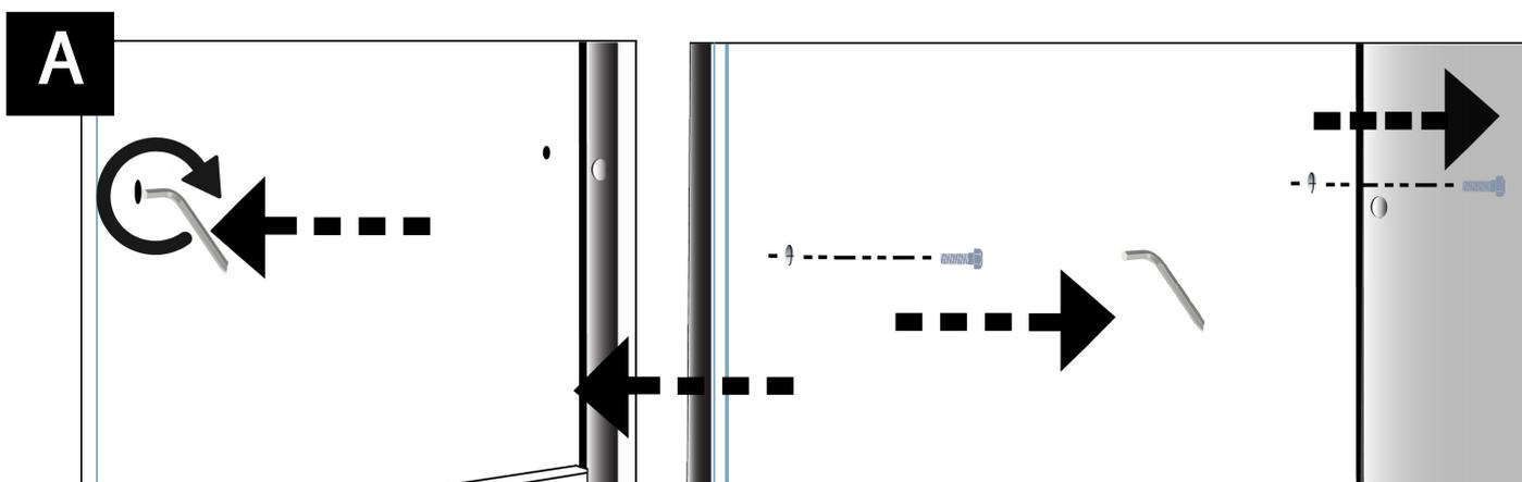
2. Insérer les ancrages des rails d'étagère à l'aide d'un tournevis cruciforme (B). Les ancrages doivent sortir environ 4 mm des parois du cabinet. Si les ancrages sont complètement vissés, les rails d'étagère ne seront pas en mesure d'être correctement fixés.
