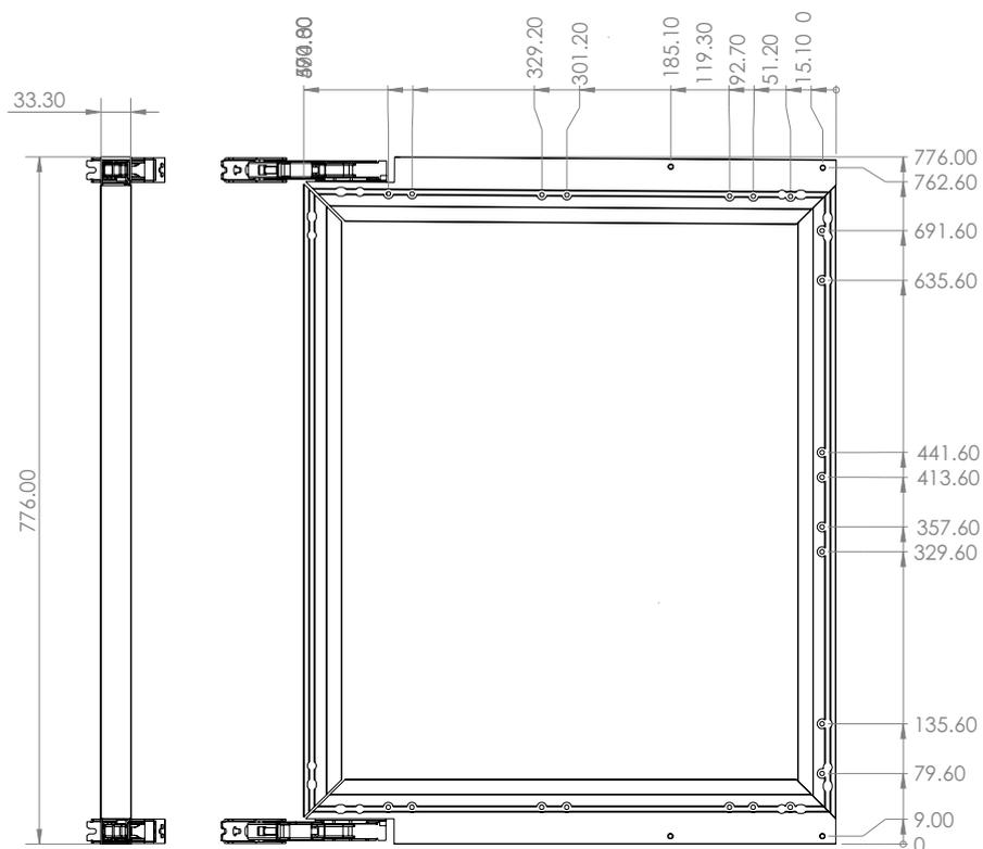
**Note B :** L'ajout de trous de diamètre M5 personnalisés peuvent être fait et percé directement dans le cadre d'aluminium.
