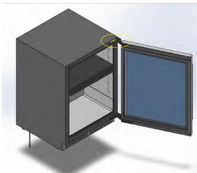
Fig.1 Localisation du support antibasculé
