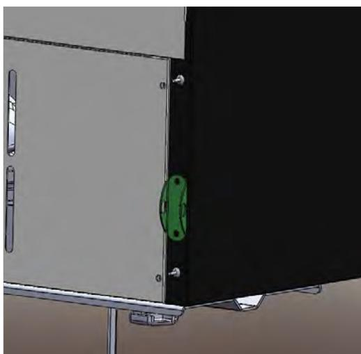
**Étape 6:** Faire passer la sangle métallique à travers les deux trous de montage des supports métalliques. Fixer la sangle en serrant le connecteur.
