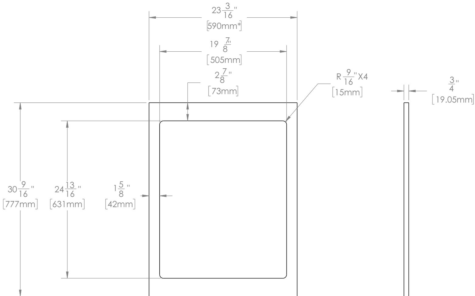
Il est recommandé que le panneau ait une largeur de 590 mm, mais une tolérance de +/- 1 mm est acceptable. De plus, le cadre en aluminium peut également accueillir des panneaux de 5/8 po d'épaisseur, mais il faudra utiliser des vis plus courtes. Veuillez en discuter avec votre installateur
