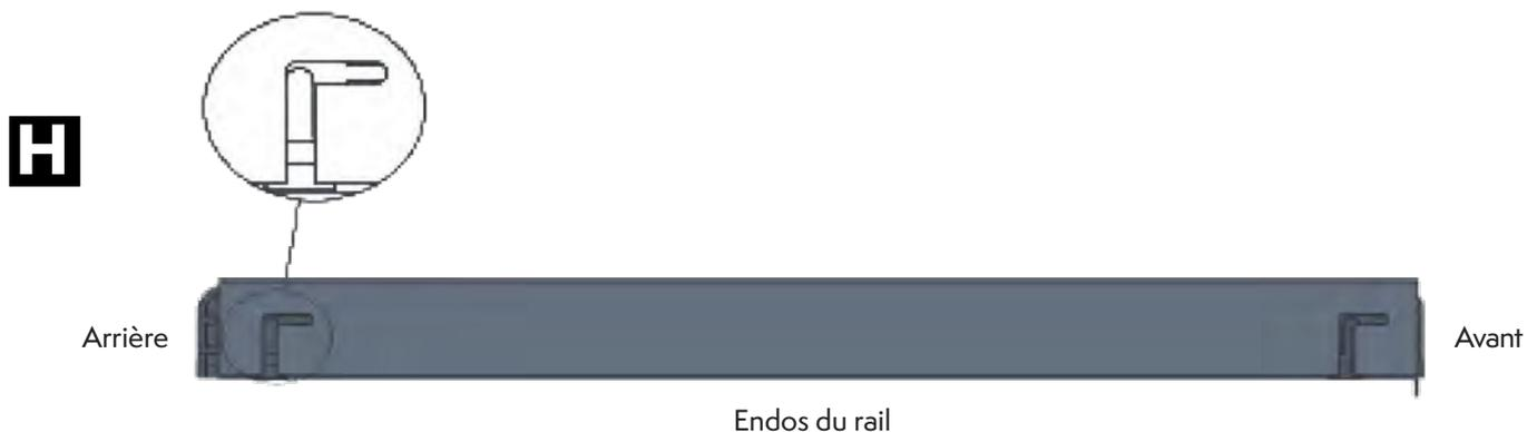
8. Pour fixer à nouveau l'étagère, tirer doucement le rail de glissière hors du refroidisseur jusqu'à pleine extension **(E)**. Remettez l'étagère sur les rails en la glissant d'abord dans les crans d'arrêt arrière, puis en déposant la portion du rail à l'avant en le cliquant dans le loquet **(D)**. Une fois cette étape terminée, l'étagère sera maintenant prête à être utilisée à la position désirée.
