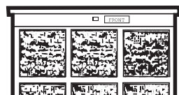
Filtro sucio – necesita limpieza
