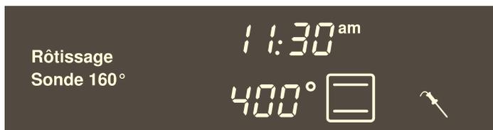
5. Régler la température interne de la sonde ; par exemple, pour régler la température de la sonde sur 145°, appuyer sur 1 4 5. Voir les tableaux de cuisson pour obtenir les températures internes appropriées.
