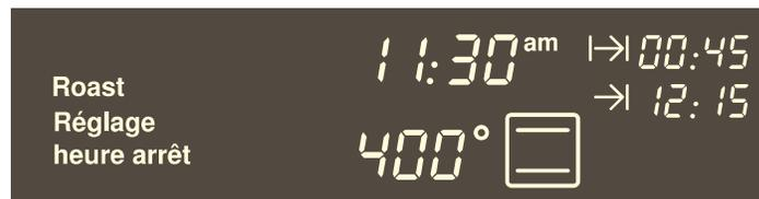
3. Entrer l'heure d'arrêt. Par exemple pour indiquer 12:45, appuyer sur les chiffres 1 2 4 5. L'heure d'arrêt programmée est affichée à côté du symbole → :
