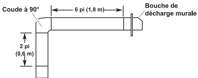
Dans l'exemple suivant, la longueur théorique du circuit est inférieure au maximum recommandé de 35 pi (10,7 m)..
