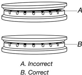
5. Allumer le brûleur. Si le brûleur ne s'allume pas, vérifier l'alignement du chapeau. Si le brûleur ne s'allume toujours pas, ne pas faire soi-même la réparation du brûleur scellé. Contacter un technicien de réparation qualifié.
