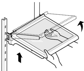
**5** Pour assembler, faites basculer l'avant de l'étagère vers le haut et guidez les crochets de l'étagère dans les fentes à la hauteur désirée.
