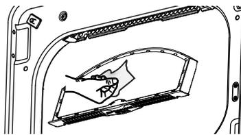
**Acier inoxydable :** Pour nettoyer les surfaces en acier inoxydable, utilisez un chiffon humide et un détergent doux non abrasif convenant aux surfaces en acier inoxydable. Retirez les résidus de produit nettoyant, puis sêchez-les avec un chiffon propre.
