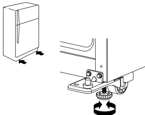
2. Ouvrir à nouveau les deux portes et vérifier que leur fermeture est aussi aisée que vous le souhaitez. Si ce n'est pas le cas, incliner le réfrigérateur un peu plus vers l'arrière en tournant les deux pieds de nivellement vers la gauche. Plusieurs tours seront peut-être nécessaires.
