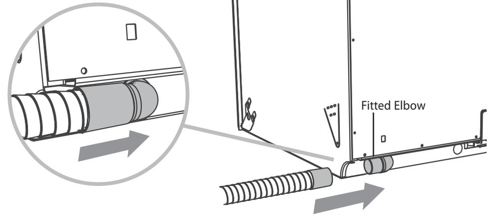
**11a) PULL THROUGH HOSES & MOVE INTO THE CAVITY**
