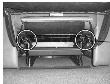
Ubicación de la rueda de ajuste, una en cada lado
