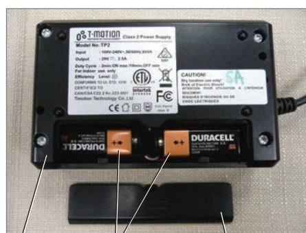
Source d'alimentation 2 piles alcalines de 9 volts Couvercle de la pile
