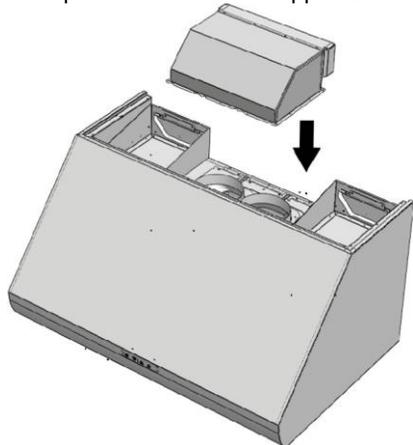
Pour la version 30", il est possible d'orienter l'air vers l'arrière de la hotte en tournant l'unité d'aspiration.
