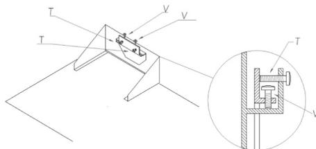
La sortie d'air de cette hotte est orientée vers le haut : si vous préférez que la sortie d'air soit orientée vers l'arrière, il suffit de remplacer la pièce d'évacuation d'air avec l'autre qui est fournie avec l'appareil.
