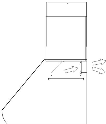
Utilisez seulement des tuyaux rigides en métal (les tuyaux en plastiques sont interdits par la loi). Les conduits flexibles limitent le flux d'air du 50%. Fixez toujours les raccords avec des vis en tôle et isolez tous les joints avec du ruban adhésif métallique ou pour conduit.
