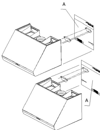
Accrochez la hotte sur les supports, puis ajustez la position horizontale et verticale de l'appareil par les vis métriques de réglage.
