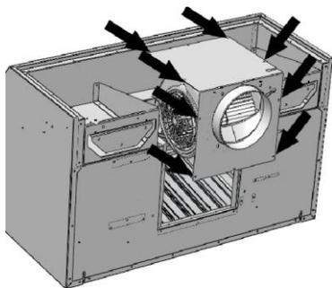
Retirez les vis, comme illustré, enlevez l'unité d'aspiration et placez-la dans la position souhaitée. Fixez l'unité avec les vis enlevées précédemment. Pour compléter l'opération, insérez les deux vis de fixation sur le côté arrière de la hotte, par les deux trous existants. Avant de positionner la cheminée, passez les câbles électriques par le tuyau décoratif et effectuez la liaison électrique.
