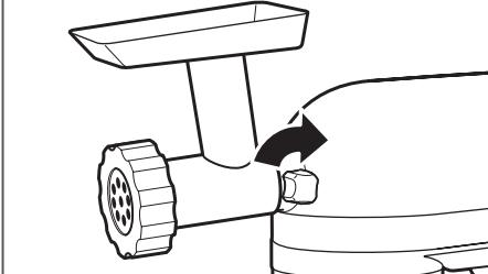
**4** Serrer le bouton à accessoires en le tournant dans le sens horaire jusqu'à ce que l'accessoire soit parfaitement fixé au batteur sur socle. Consulter le manuel d'instructions fourni avec votre accessoire pour obtenir des indications précises sur son utilisation.
