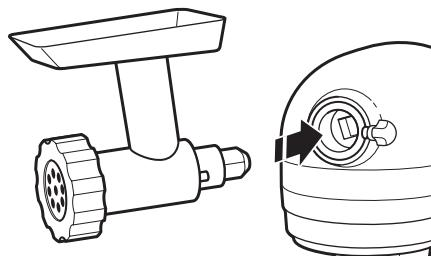
**3** Inserte el aditamento en el receptáculo de este, asegurándose de que el eje de potencia del aditamento encaje dentro de la cavidad cuadrada del receptáculo para aditamentos. Puede ser necesario girar el aditamento hacia atrás y hacia adelante. Cuando está en la posición correcta, la clavija del aditamento encarájera en la muesca del borde del receptáculo.
