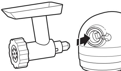
**3** Insérer l'accessoire dans la prise à accessoires, en s'assurant que l'arbre de commande s'adapte à la douille de prise carrée. Il faudra peut-être faire pivoter l'accessoire en l'insérant. Lorsqu'il est en position correcte, le goujon de l'accessoire s'adapte à l'encoche du pourtour de la prise.
