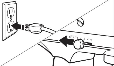
Brancher le batteur sur socle sur une prise à 3 alvéoles reliée à la terre. Toujours régler la commande de vitesse à la plus basse vitesse pour commencer, puis augmenter graduellement la vitesse pour éviter que les ingrédients n'éclaboussent. Consulter le « Guide de commande de vitesse » pour sélectionner la vitesse appropriée pour votre recette.
