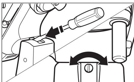
**(OPTIONEL)** Pour régler le batteur avec le dégagement du bol : Incliner la tête de moteur vers l'arrière, puis tourner légèrement la vis dans le sens antihoraire (gauche) pour soulever le batteur ou horaire (droite) pour l'abaisser. Réglé le batteur pour qu'il ne touche pas à la surface du bol. Le surajustement de la vis pourrait empêcher le levier de verrouillage de fonctionner correctement.
