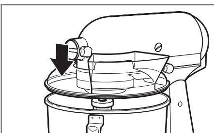
**(OPTIONEL)** Ajouter l'écran verseur\*: Glisser l'écran verseur à partir de l'avant du mélangeur sur socle, par-dessus le bol, jusqu'à ce qu'il soit centré. Le pourtour inférieur de l'écran verseur s'adapte à l'intérieur du bol. Le bec verseur se situera légèrement sur la droite de la prise à accessoires lorsqu'on fait face au batteur sur socle.
