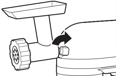
**4** Apriete la perilla del aditamento girándola hacia la derecha, hasta que el aditamento esté asegurado por completo a la batidora con base. Consulte el Manual de instrucciones que viene con su aditamento para obtener instrucciones detalladas sobre cómo utilizarlo.
