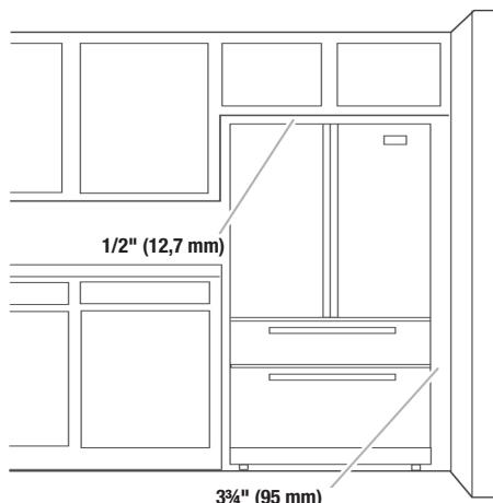
Para asegurar la adecuada ventilación para su refrigerador, se recomienda dejar un espacio de 1/2" (1,27 cm) a cada lado y en la parte de arriba del refrigerador. Deje un espacio de 1" (2,54 cm), como mínimo, entre la parte posterior del gabinete y la pared (considere el condensador como parte posterior si está presente). Si el refrigerador tiene fábrica de hielo, asegúrese de dejar espacio adicional atrás para las conexiones de la línea de agua.
