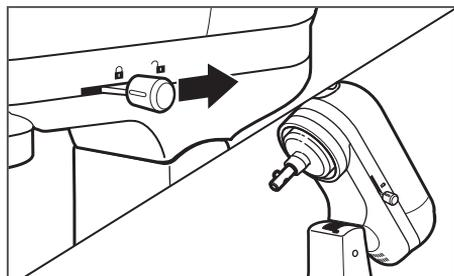
**1 Levante la cabeza con motor:** Verifique que la batidora con base esté desconectada y el control de velocidad esté ajustado en "0"; después deslice la palanca de bloqueo a la posición de desbloqueo y levante la cabeza con motor. En cuanto esté levantada, deslice la palanca de bloqueo a la posición de bloqueo para mantener la cabeza con motor levantada.
