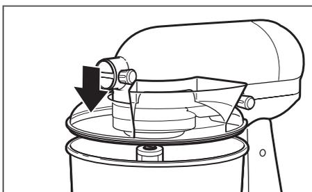
**(OPCIONAL) Coloque el escudo vertedor\*:** Deslice el escudo vertedor\* con base sobre el tazón hasta que esté centrado. La parte inferior del borde del escudo vertedor\* deberá encajar dentro del tazón. El conducto para verter estará a la derecha del eje del aditamento cuando usted esté de frente a la batidora con base.
