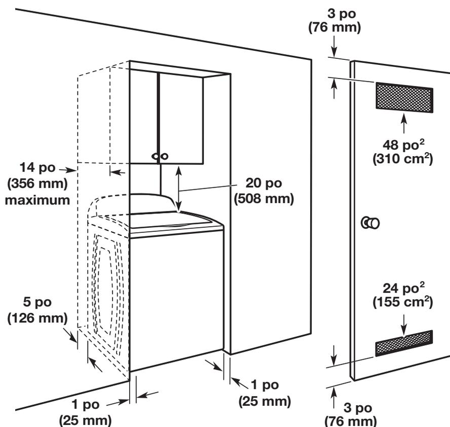
Les dimensions représentent les dégagements recommandés permis, hormis pour les ouvertures de ventilation de la porte de l'armoire qui correspondent aux dimensions minimales nécessaires.
