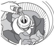
**REMARQUE :** Si de l'assouplissant pour tissu est ajouté, utiliser toujours le bouton Soil & Rinse (saleté et rinçage) pour sélectionner un réglage avec « +Extra Rinse » (+ rinçage supplémentaire). Ceci assurera qu'il ne reste aucun assouplissant pour tissu sur les vêtements une fois le programme terminé.
