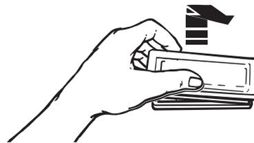
3. Ôter l'ampoule de la douille.
