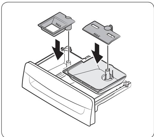
3. Retirez les fixations au niveau des compartiments. Rincez les fixations et le tiroir à l'eau tiède et nettoyez-les à l'aide d'une brosse souple.
