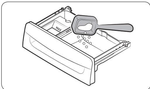
Retirez d'abord le bac à lessive liquide fourni dans le compartiment de lessive. Ensuite, ajoutez de la lessive en poudre dans le compartiment de lessive en respectant les instructions du fabricant de la lessive.
