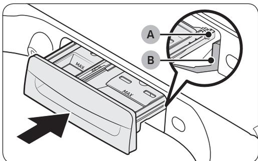
5. Réinstallez les fixations sur les compartiments appropriés. Réinstallez le tiroir en plaçant le **rail du tiroir (A)** sur le **rail du compartiment (B)**, tout en inclinant le tiroir vers le bas.
