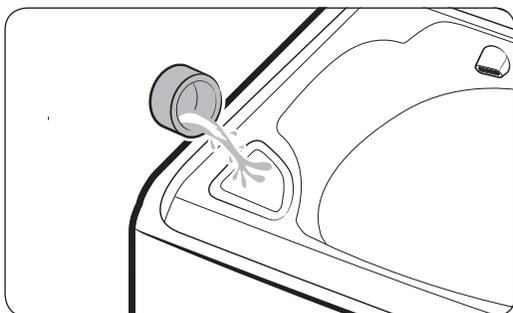
Ajoutez uniquement de l'eau de Javel chlorée liquide dans le compartiment d'eau de Javel. Ne dépassez pas le trait de remplissage maximum.
