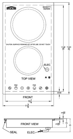
MODEL: CR2B23T3B CR2B23T4W 220-240V-60HZ 3000W MAX.
