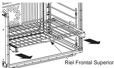
Si resulta difícil extender estos estantes, lubrique los mismos con lubricante de grafito, provisto con el horno. Retire el estante del horno, retire cualquier obstrucción en el recorrido deslizable con una toalla de papel, agite el lubricante de grafito y coloque 4 gotitas en los dos recorridos inferiores de los lados izquierdo y derecho. Abra y cierre el estante varias veces para distribuir el lubricante.
