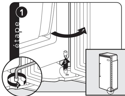
Ouvrez la porte de l'appareil afin que la butée de porte et la vis à épaulement soient accessibles.
