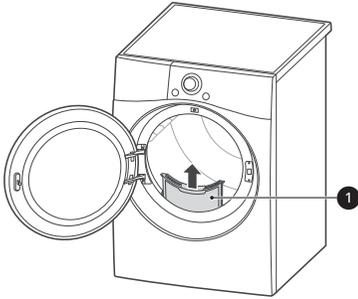
Assurez-vous que le filtre à charpie soit toujours correctement installé avant de démarrer la sécheuse. Un fonctionnement de la sécheuse avec un filtre mal fixé ou manquant risquerait d'endommager la sécheuse et les articles dans la sécheuse.
