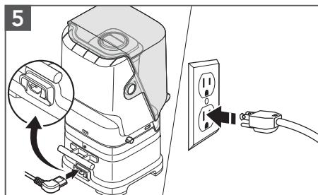
Asegúrese de que el interruptor de encendido esté en posición OFF (Apagado). Coloque de manera segura el cable eléctrico desmontable en la parte de atrás de la licuadora. Enchufe la licuadora en un tomacorriente de 3 terminales con descarga a tierra.
