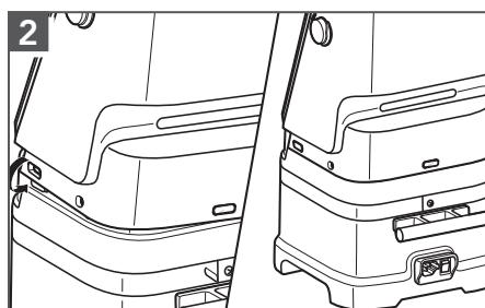
2) Fixer les deux côtés sur les onglets des deux côtés de la base du mélangeur.
