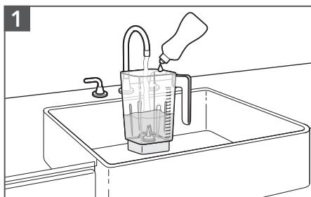
Remplir le récipient à moitié d'eau tiède et ajouter 1 à 2 gouttes de savon à vaisselle liquide. Fixer le couvercle et le bouchon de couvercle. Placer le récipient sur la base. Fermer le couvercle avant.
