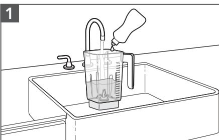
Llene la mitad de la jarra con agua tibia y agregue 1 o 2 gotas de líquido lavavajillas. Coloque la tapa y la tapa para ingredientes. Coloque la jarra sobre la base. Cierre la cubierta frontal.
