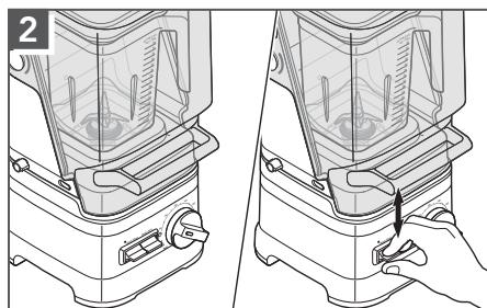
Faire tourner le bouton de commande sur 50 secondes. Faire basculer l'interrupteur MARCHE/ARRÊT vers le haut ou le bas. Une fois le temps terminé, retirer et vider le contenu et rincer à l'eau tiède, puis sécher soigneusement.
