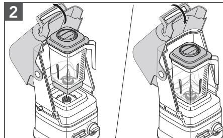
Ouvrir le couvercle avant. Placer le récipient du mélangeur sur la base, aligné avec le capuchon. Fermer le couvercle avant.
