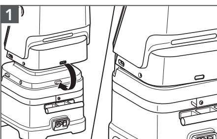
1) Installer le couvercle arrière en alignant l'onglet sur le côté arrière de la base avec la fente du couvercle arrière.
