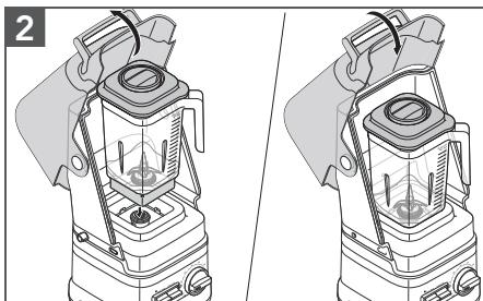
Abra la cubierta frontal. Coloque la jarra de la licuadora en la base, alineada con la base de la jarra. Cierre la cubierta frontal.
