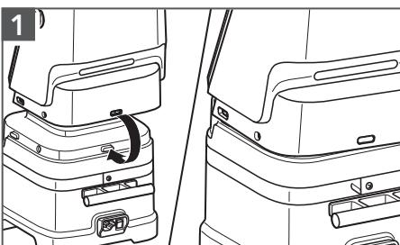
Instale la contraportada alineando la lengüeta en la parte posterior de la base con la ranura en la contraportada.
