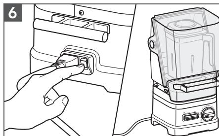
Mueva el interruptor de encendido hacia la posición ON (Activado) (I). La luz indicadora de estado se encenderá de manera intermitente, lo que indica que la licuadora está en modo de espera y lista para funcionar.
