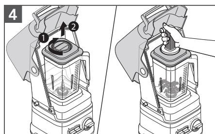
Utiliser le poussoir (facultatif) : Ouvrir le couvercle avant. Ne retirer que le bouchon de couvercle. Remuer le contenu ou appuyer dessus pour le diriger vers la lame. Une fois terminé, replacer le bouchon de couvercle avant de poursuivre.
