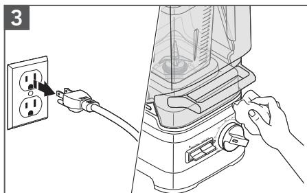
Débrancher avant de nettoyer. Essuyer la base et le cordon avec un chiffon mouillé d'eau tiède, puis les sécher avec un chiffon doux.
