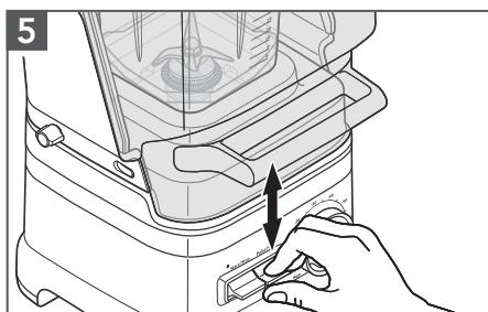
Utiliser le mode impulsions (facultatif) : Maintenir vers le haut l'interrupteur d'IMPULSION à bascule pour une pulsation plus rapide ou vers le bas pour une pulsation plus lente.
