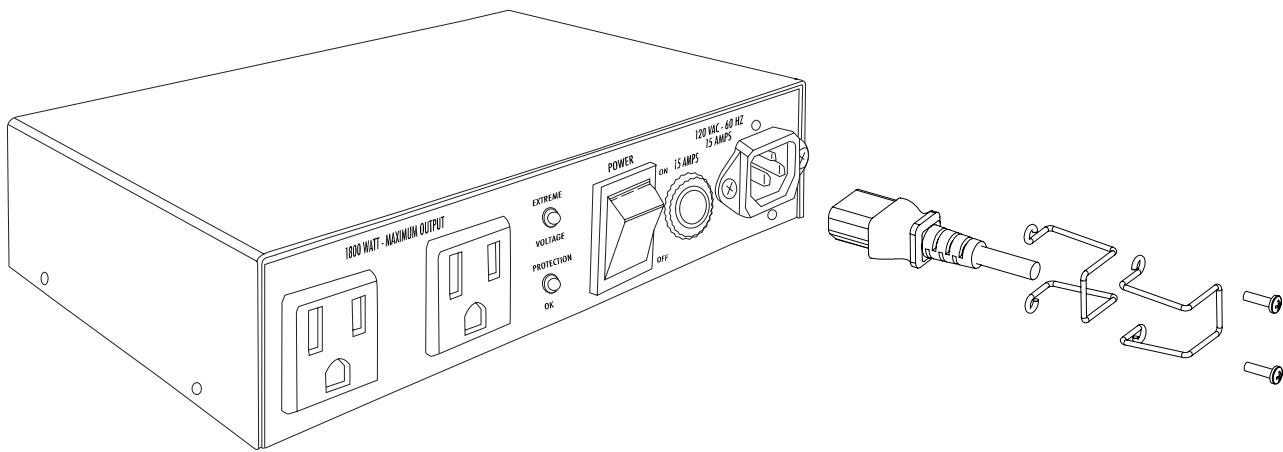
Para atar o separar la abrazadera de la seguridad de la cuerda de la corriente ALTERNA, monte o desmonte simplemente según las indicaciones de la ilustración antedicha. Coloque la abrazadera junto como se muestra, y asegure los tornillos en los agujeros proporcionados para trabar el cable eléctrico en el lugar. Afloje los tornillos y quite la abrazadera de unidad para separar.
