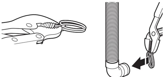
3. Serrer la bride avec une pince et faire glisser l'extrémité coudée du tuyau de vidange sur l'orifice de vidange de la laveuse, puis fixer avec la bride.
