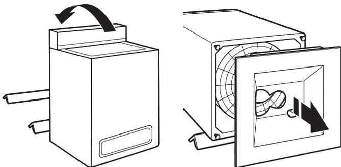
3. Retirer le ruban adhésif du couvercle de la laveuse, ouvrir le couvercle et retirer le carton plat d'emballage de la cuve. Veiller à retirer toutes les pièces du carton plat.
