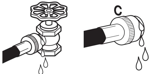
**REMARQUE :** Remplacer les tuyaux d'arrivée d'eau après 5 ans d'utilisation pour réduire le risque de défaillance intempestive. Prendre note de la date d'installation ou de remplacement des tuyaux d'arrivée d'eau, pour référence ultérieure.
