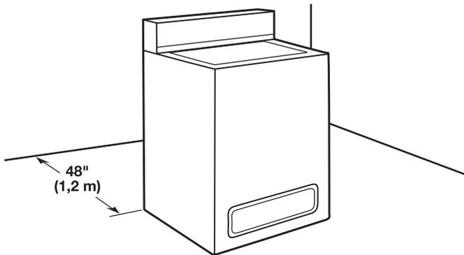
2. Afin d'éviter d'endommager le plancher, placer les supports en carton du carton d'expédition sur le plancher, derrière la laveuse. Incliner la laveuse vers l'arrière et la placer sur les supports en carton. Retirer la base d'expédition. Redresser la laveuse en position verticale.
