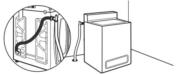
Le système de vidange au plancher nécessite un ensemble de brise-siphon (pièce numéro 285834). Dimension minimale pour le brise-siphon : 28" (710 mm) à partir du fond de la laveuse. Des tuyaux supplémentaires peuvent être requis.
