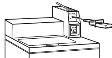
Installer un verrou et une came sur la porte de service du boîtier du compteur. Installer la chambre à pièces et son verrou dans l'ouverture du boîtier du compteur.
