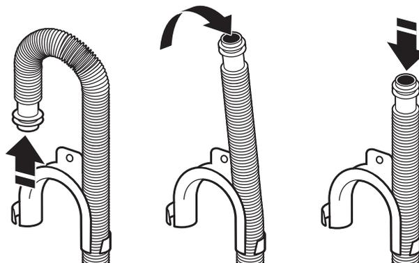
7. Le système de vidange au sol nécessite un brise-siphon qui peut être acheté séparément. Le brise-siphon (pièce numéro 285834) doit se trouver au moins à 28" (710 mm) de la base de la laveuse. Des tuyaux supplémentaires peuvent s'avérer nécessaires.
