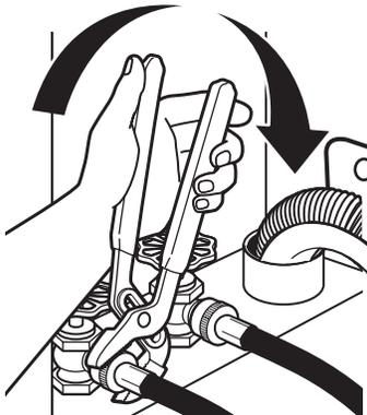
**IMPORTANT :** Ne pas serrer excessivement ni utiliser de ruban adhésif ou de dispositif d'étanchéité sur la valve lors de la fixation aux robinets ou à la laveuse. Cela pourrait entraîner des dommages.
