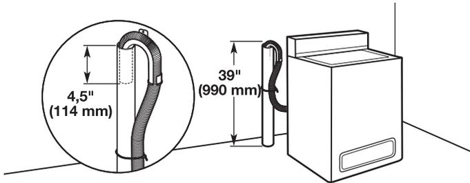
Diamètre minimal pour un tuyau de rejet à l'égout : 2" (51 mm).
