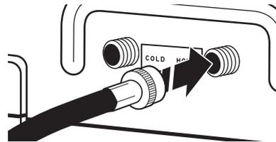
2. Fixer le tuyau d'eau chaude au robinet d'arrivée d'eau chaude indiquée par une bague rouge. Visser le raccord à la main jusqu'à ce qu'il soit bien serré.
