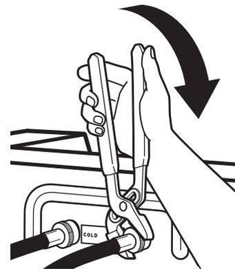
**REMARQUE :** Ne pas serrer excessivement. Les robinets risquent d'être endommagés.
