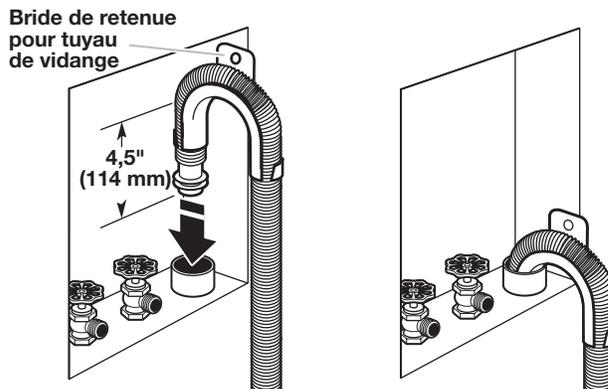
6. Pour les installations avec vidange au plancher, il faut retirer la bride de retenue pour tuyau de vidange de l'extrémité du tuyau de vidange. Des pièces supplémentaires avec des directives distinctes seront peut-être nécessaires. Voir "Outillage et pièces".
