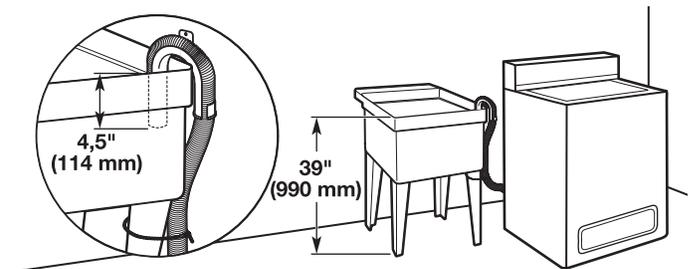
Capacité minimale : 20 gal. (76 L). Le sommet de l'évier de buanderie doit se trouver à au moins 39" (990 mm) du plancher.
