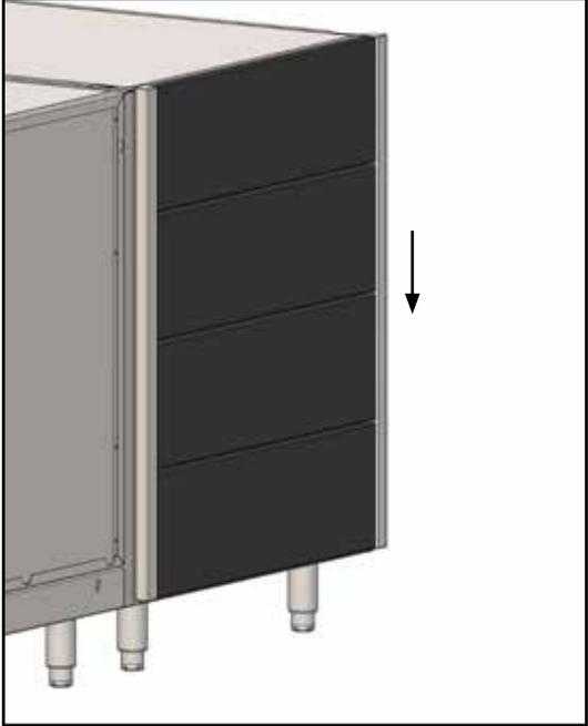
INSTALL THE BACK FINISHING PANELS
