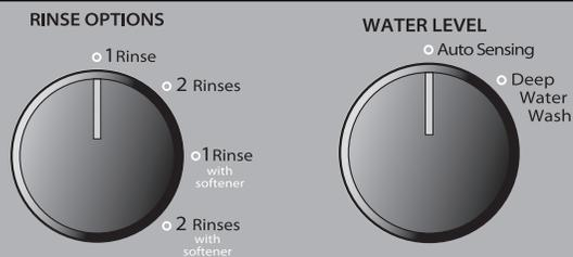
Sélectionner le nombre de rinçages en tournant les options de rinçage bouton pour le réglage désiré.
