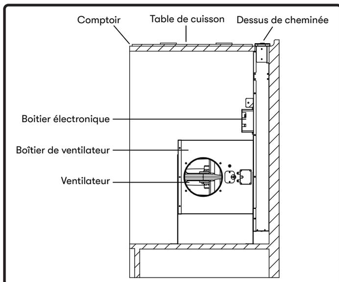
**REMARQUE:** Le boîtier électronique peut être déplacé vers le côté gauche ou droit du boîtier du ventilateur.
