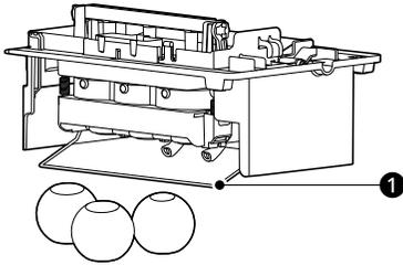
❶ Dispositif d'arrêt automatique (levier)
