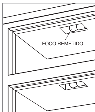
Iluminación de los cajones de almacenamiento.
